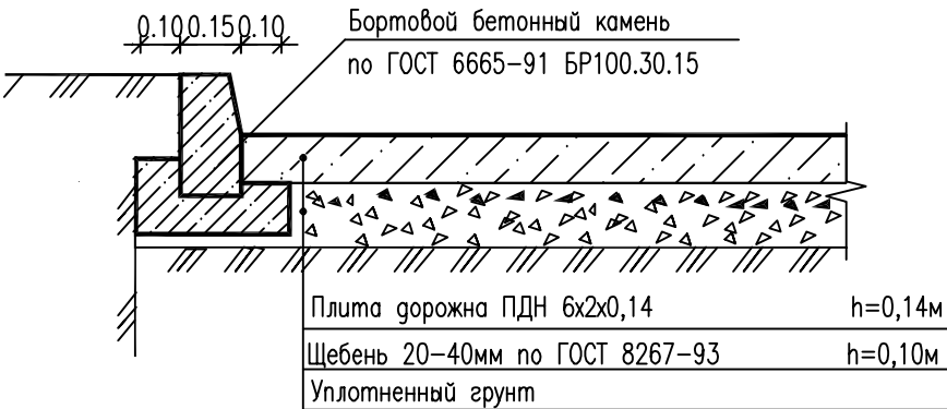
Конструкция одежды проезда М 1:20
